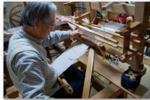
村野さんのご自宅でお持ちの機織り機。50cm程の大きな枠でよこ糸を入れようとしている様子。
